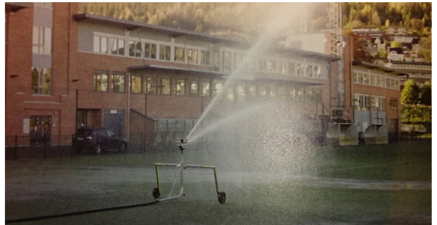
Figur 9: Eksempel på automatisk vandingsanlæg for rektangulær bane.
